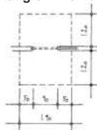
Bild 10: Bewegungsfläche vor handbetätigten Schiebetüren
