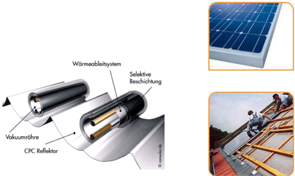
Bild 42: Schemata Warmwasserkollektoren und Photovoltaikanlagen
