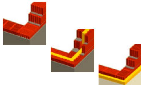
Für ein **Wandsysteme aus Ziegel und Vollwärmeschutz** für den Einfamilienhausbereich sind 20-25 cm tragende Schale und ca. 26-30 cm Dämmung erforderlich.
