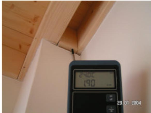
**Leckage Eckverbindung Holzkonstruktion:**
