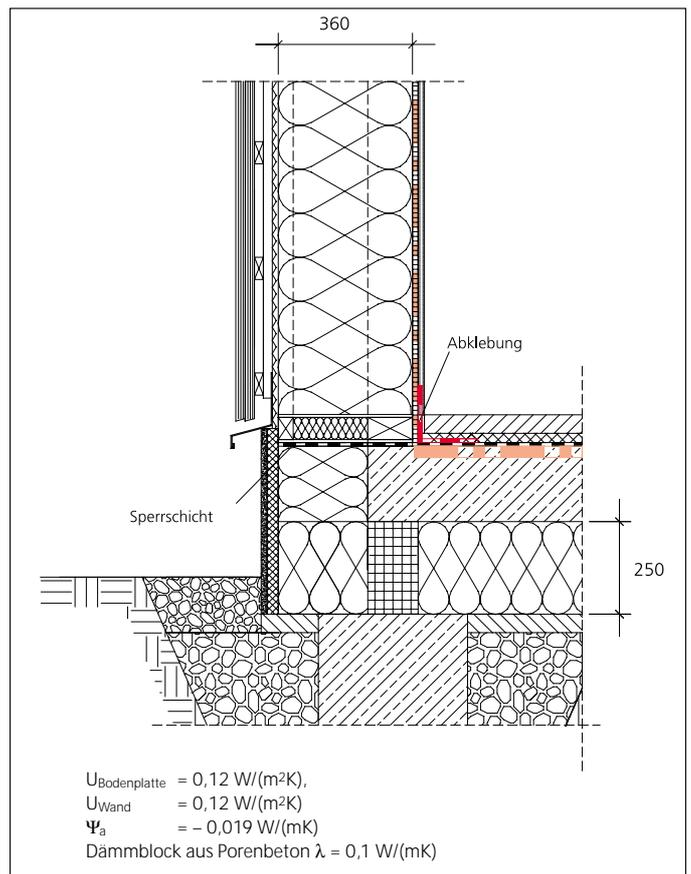
Abbildung 13 Bodenplatte mit Streifenfundament und thermisch getrennter Lastabtragung.
