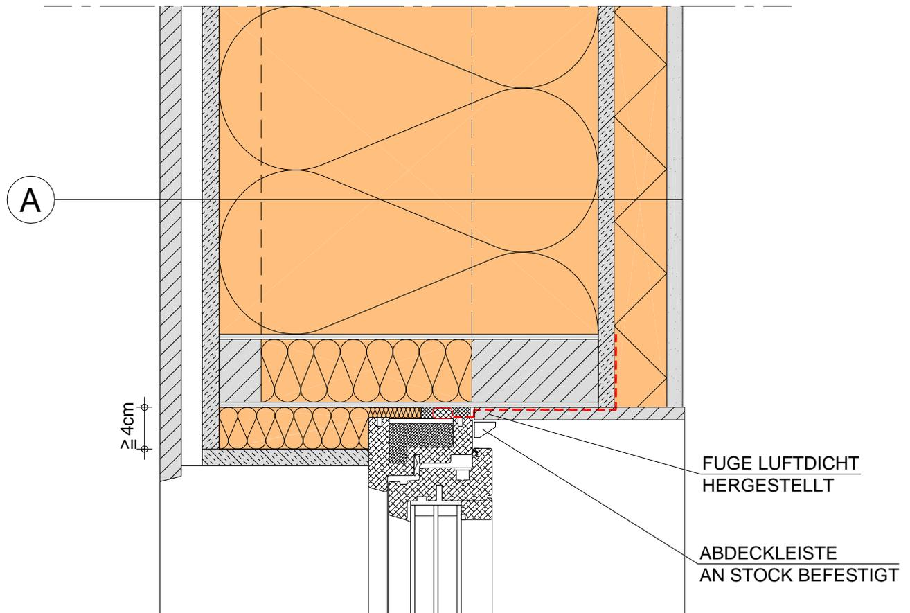
Bei der Stocküberdämmung sind die Einbaurichtlinien des Fensterherstellers zu beachten
