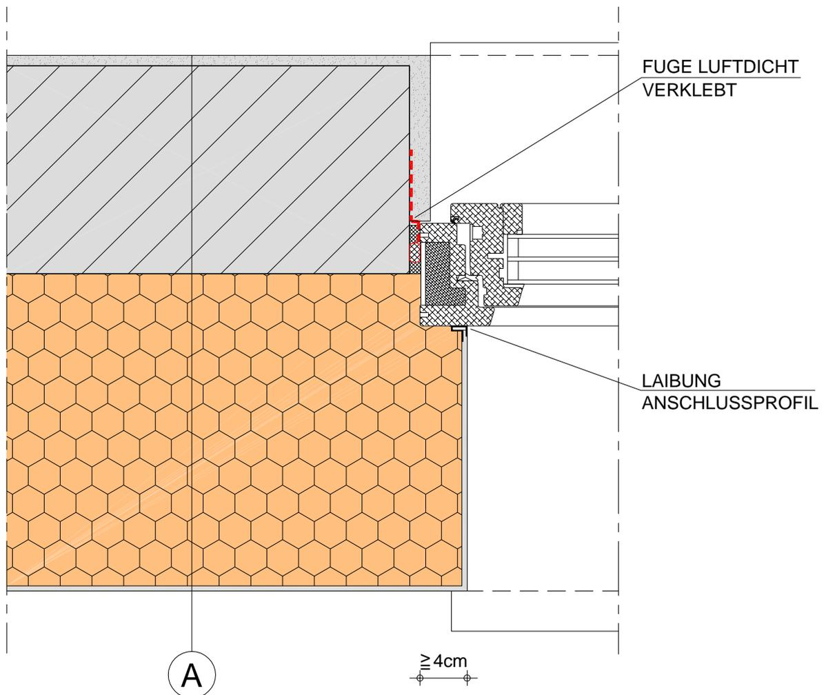
Bei der Stocküberdämmung sind die Einbaurichtlinien des Fensterherstellers zu beachten
