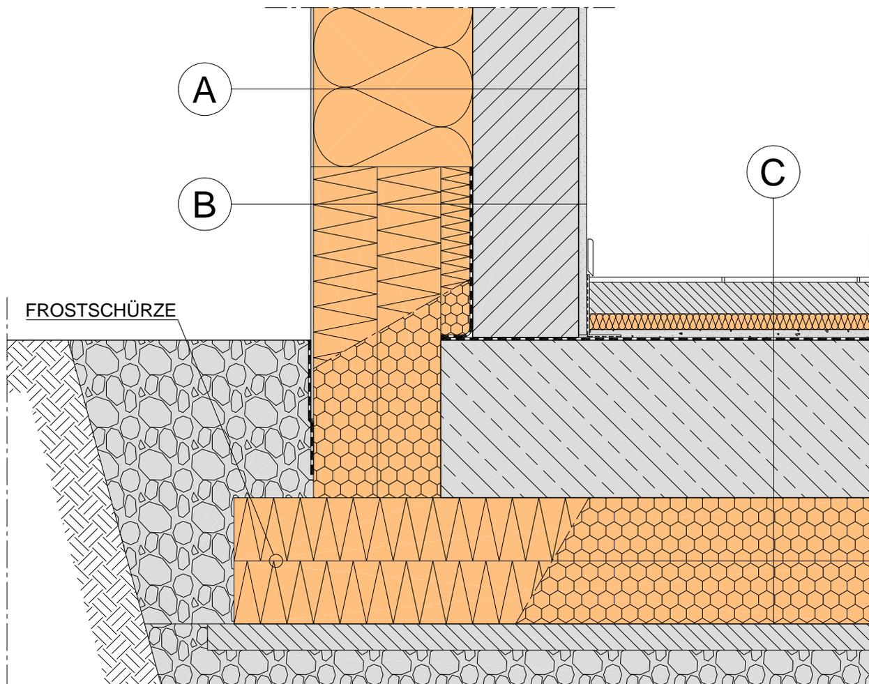
\*) Bei einlagiger Verlegung nur mit Lamellen möglich. Bei der Berechnung des Wärmeschutzes ist der Einfluss der Verdübelung zu berücksichtigen.
