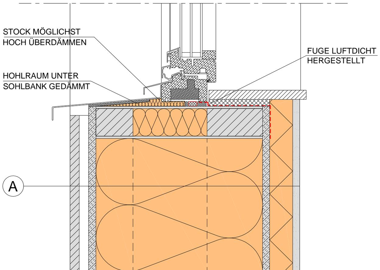
Bei der Stocküberdämmung sind die Einbaulinien des Fensterherstellers zu beachten
