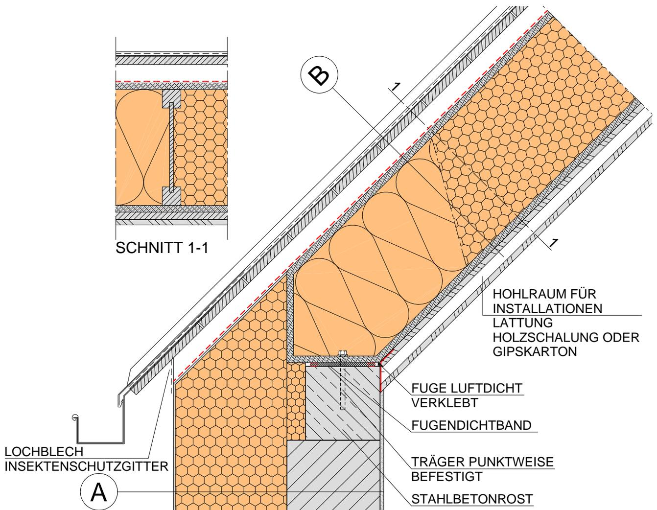
\*) Bei der Berechnung des Wärmeschutzes ist der Einfluss der Verdübelung zu berücksichtigen.
