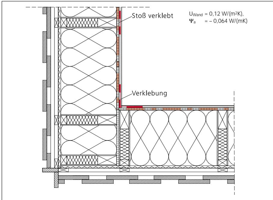
net wird. Deshalb müssen Wärmebrückenverlustkoeffizienten von Anschlüssen für das Passivhaus mit den Bauteilaufbauten berechnet werden, die im Passivhaus tatsächlich vorkommen, d.h. mit  $U_{Wand} \leq 0,15 \text{ W/(m}^2\text{K)}$ . Dies bedeutet aber weiterhin:  $\Psi$ -Werte aus Datensammlungen von konventionellen Bauteilen dürfen nur mit größter Vorsicht auf das Passivhaus übertragen werden.
