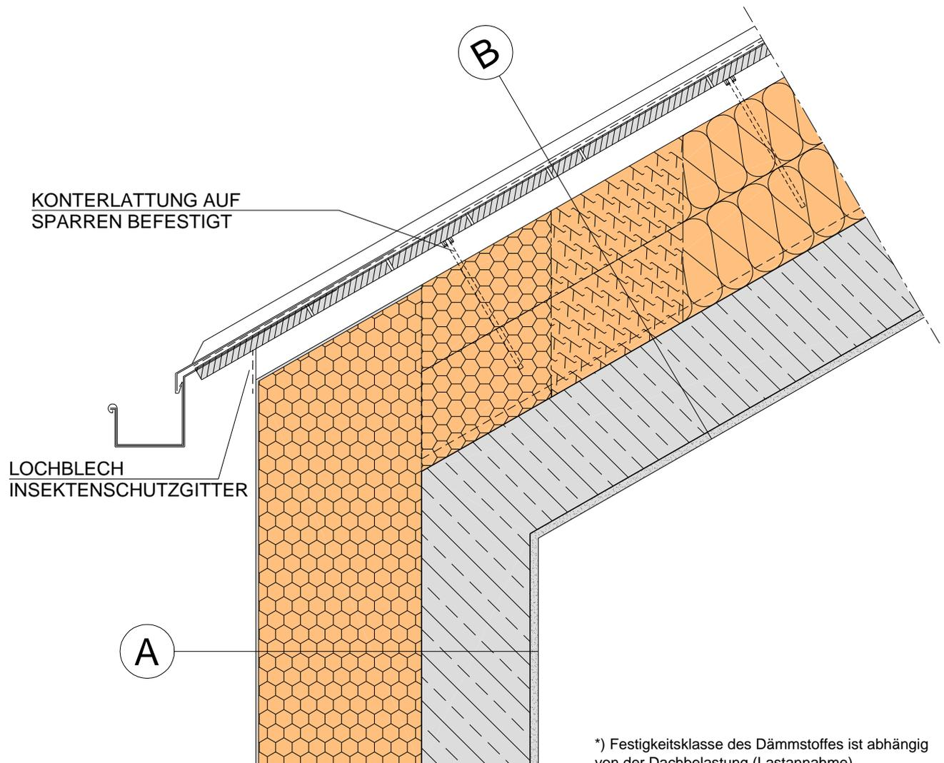
\*) Festigkeitsklasse des Dämmstoffes ist abhängig von der Dachbelastung (Lastannahme).
