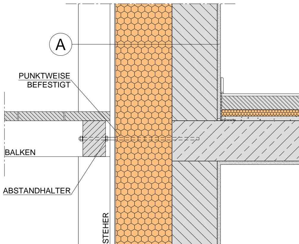
\*) Bei der Berechnung des Wärmeschutzes ist der Einfluss der Verdübelung zu berücksichtigen.
