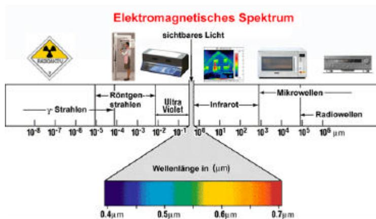
Der Infrarot-Bereich ist langwelliger als das sichtbare Licht und schließt an den Rotbereich an. Für das menschliche Auge sind diese Wellenlängen nicht mehr sichtbar, einige Tierarten (Schlangen, Bienen) können aber im Infrarot-Bereich „sehen“.
