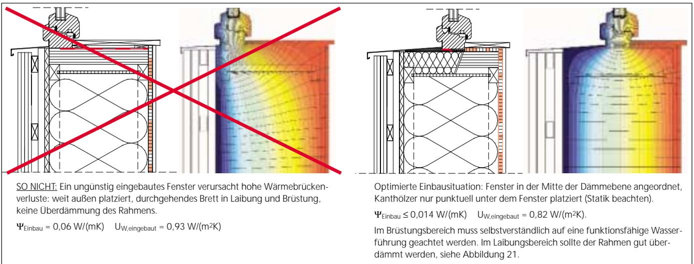
Abbildung 20 Prinzipskizzen für Fenstereinbau in eine Wand mit  $U_{\text{Wand}} = 0,12 \text{ W}/(\text{m}^2\text{K})$ , jeweils mit Isothermenverlauf. Fenster U-Wert:  $U_w = 0,78 \text{ W}/(\text{m}^2\text{K})$
