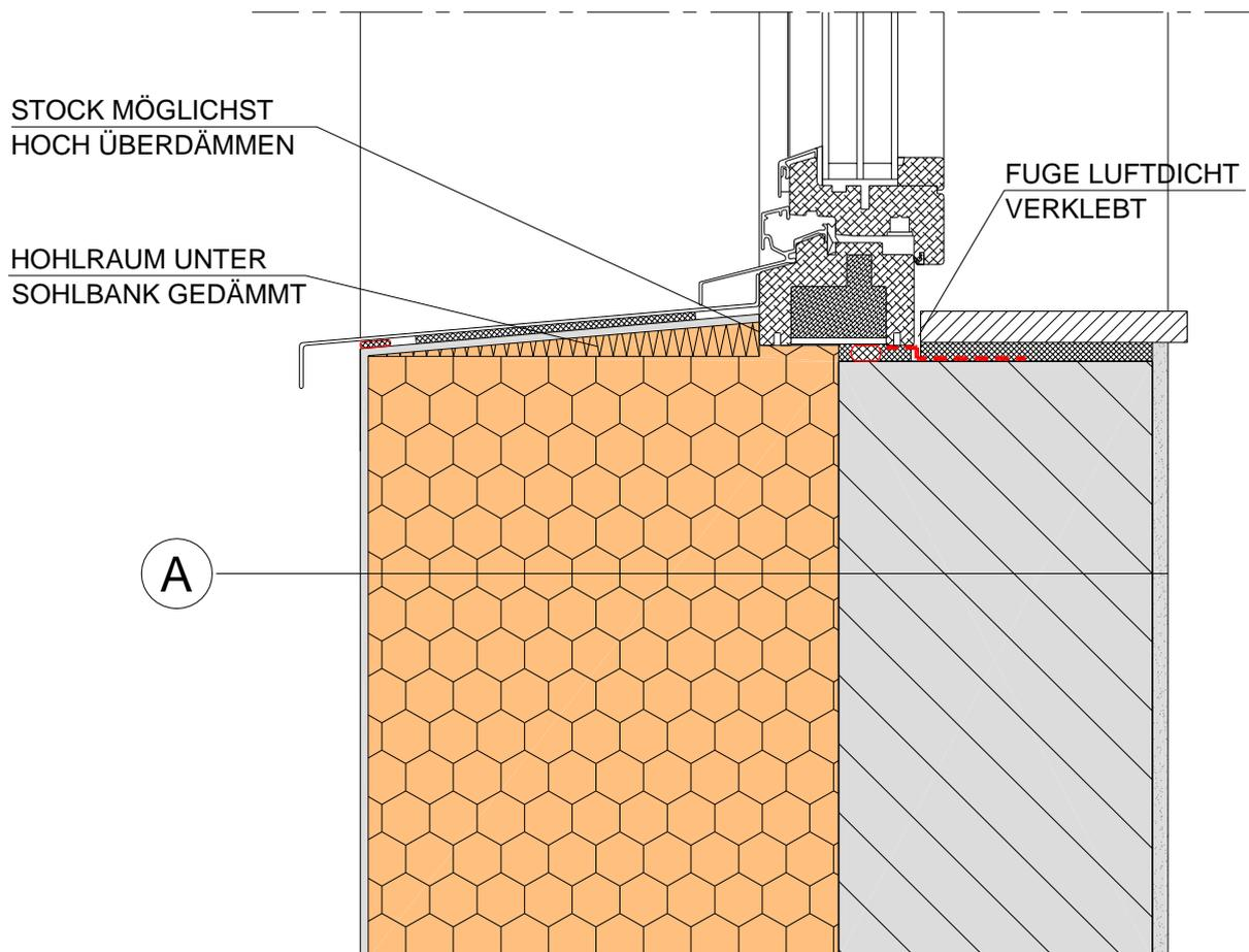
Bei der Stocküberdämmung sind die Einbaurichtlinien des Fensterherstellers zu beachten
