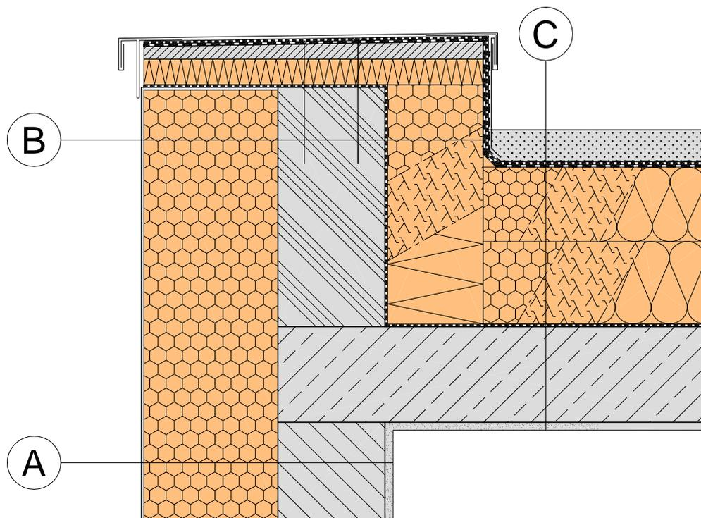
Gefälleausbildung durch Gefälledämmplatten oder Gefällebeton
