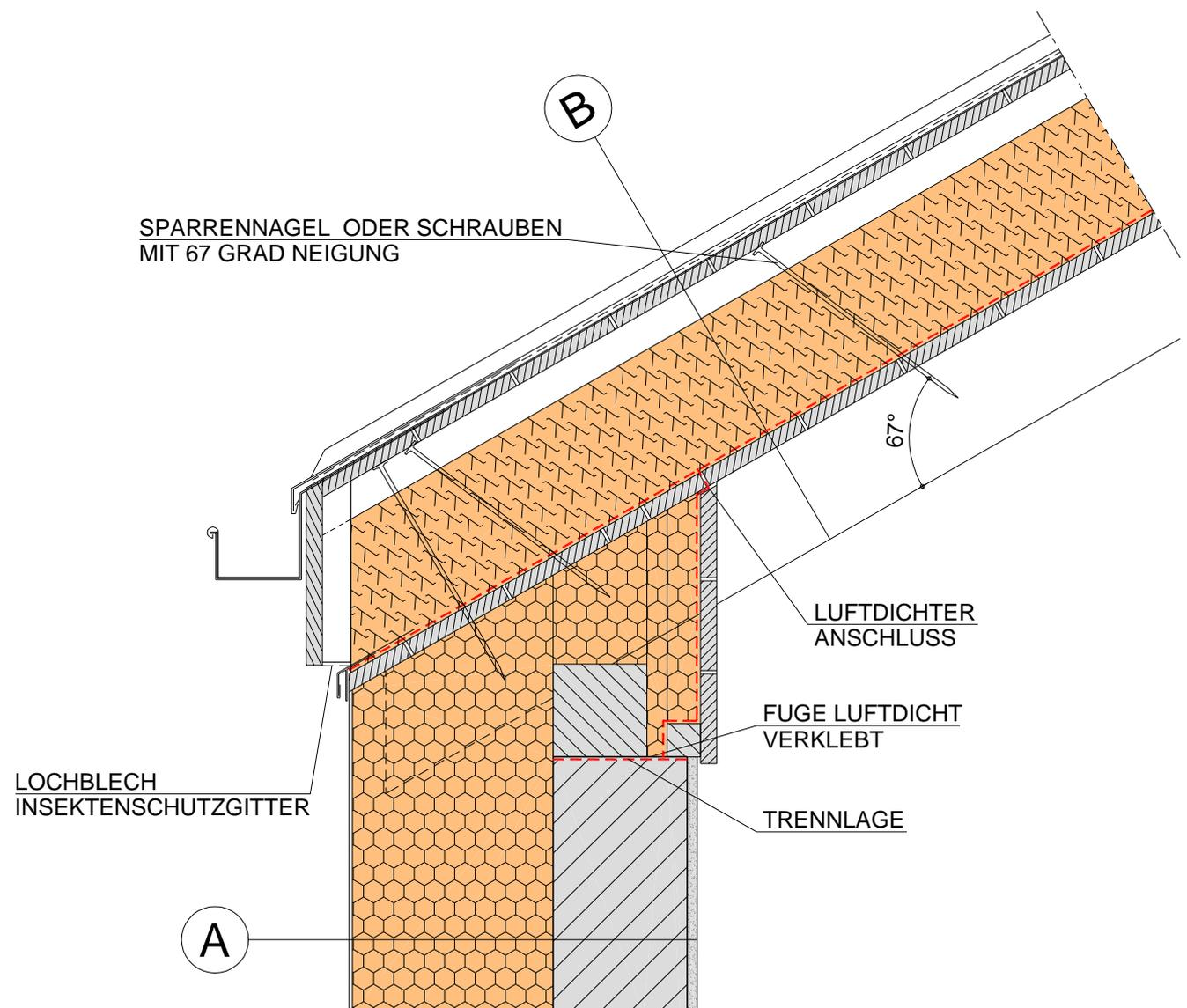
\*) Bei der Berechnung des Wärmeschutzes ist der Einfluss der Verdübelung zu berücksichtigen.
