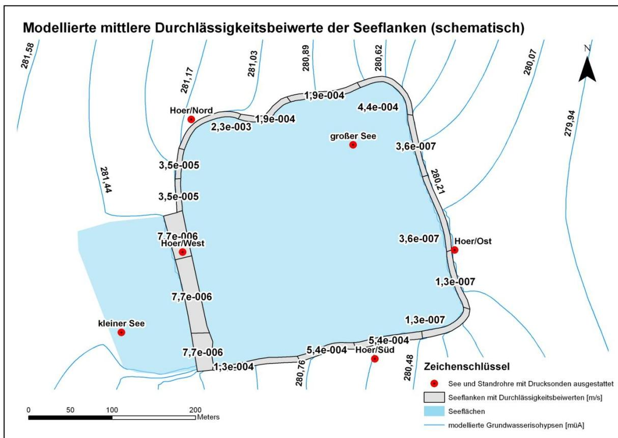
Abb. 5: Modellierte mittlere Durchlässigkeitsbeiwerte [m/s] der Seeflanken des Baggersees in Hörsching (schematisch)
