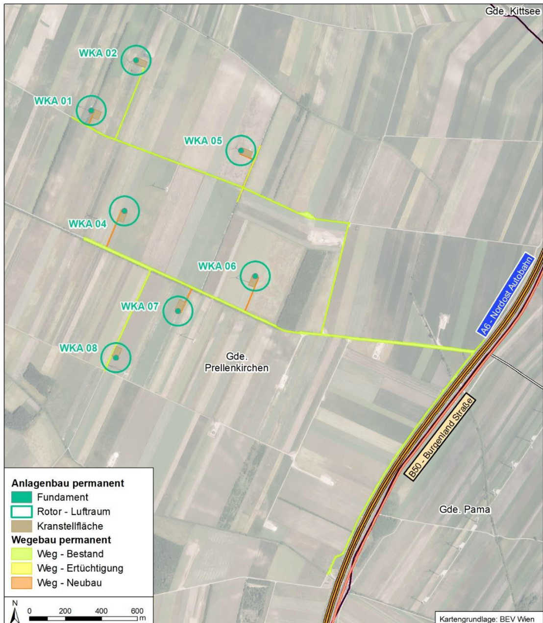
Abbildung 1: Übersicht – Wegebau und Anlagenstandorte
